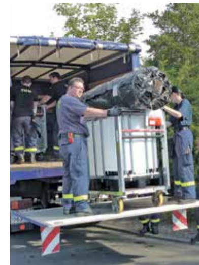
Die Anlage ist modular aufgebaut und kann im Lkw leicht transportiert werden. Die Wanne wird ausgerollt und darüber die Sprüheinrichtung montiert.
