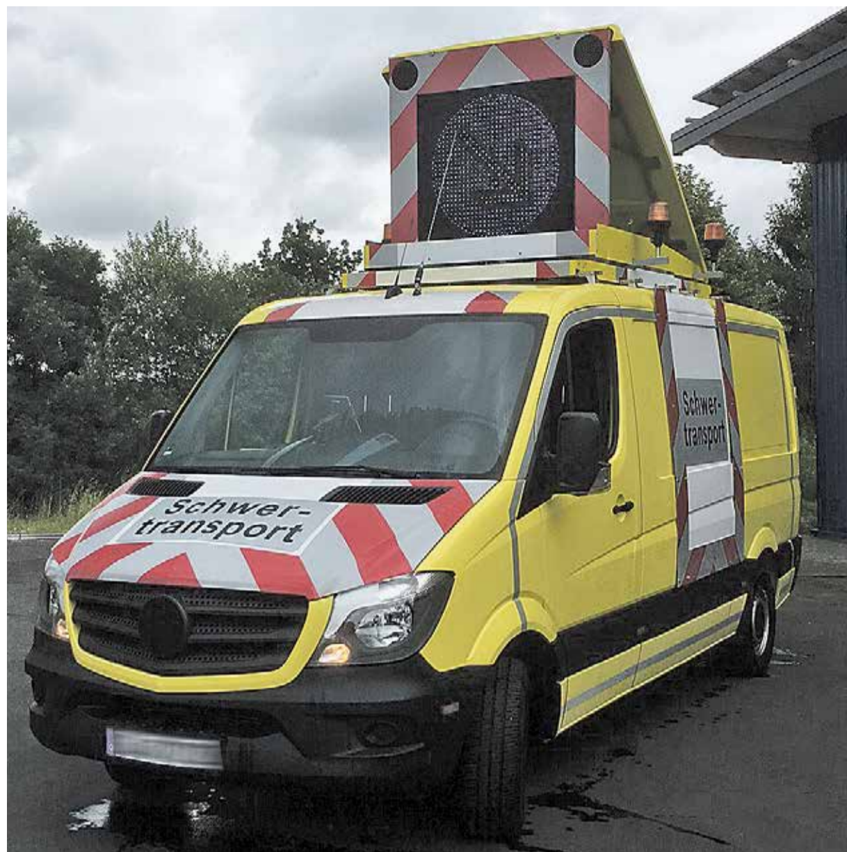
Mit ihrem auffallenden Gelb werden die neuen Begleiter von Schwertransporten schnell wahrgenommen und mit dem Dachaufsatz können verschiedene Verkehrszeichen angezeigt werden.
