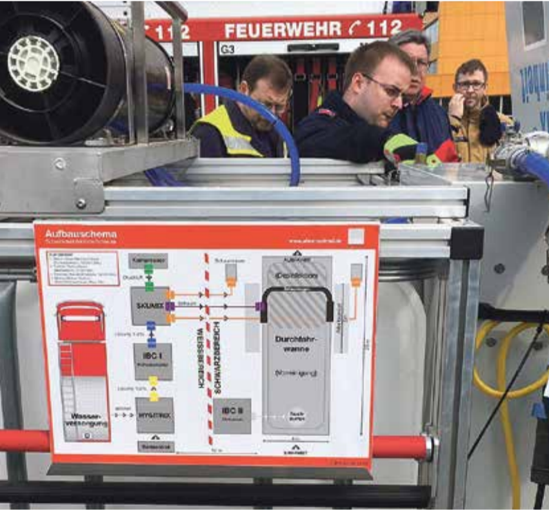
Der Aufbau der Desinfektionsschleuse umfasst zahlreiche Komponenten.
