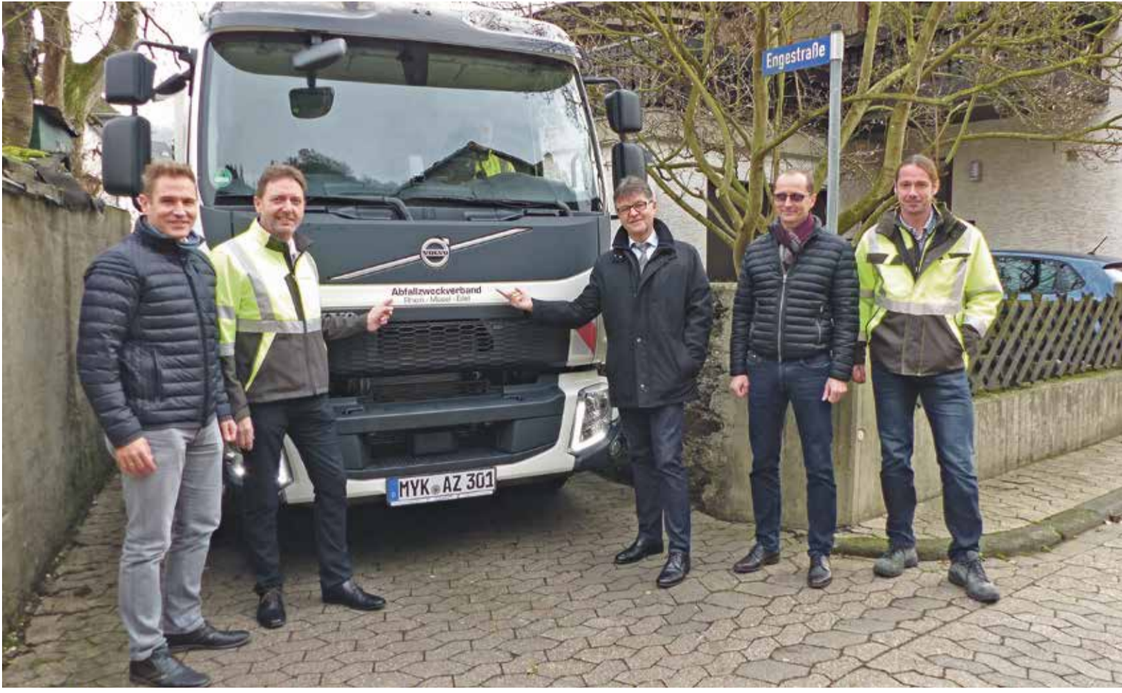
Das neue Mini-Müllfahrzeug ist 7,17 m lang, 2,26 m breit, 2,91 m hoch und fasst ein Volumen von 8,5 Kubikmetern. Im Vergleich dazu sind die herkömmlichen Fahrzeuge 9,90 m lang, 2,55 m breit, 3,42 m hoch und haben ein Volumen von 20 Kubikmetern.
